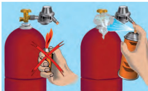
Abb. 17: Dichtheitsprüfung mittels Lecksuchspray
