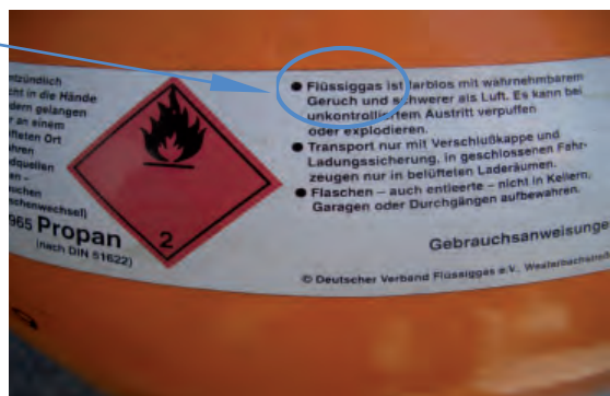
Abb. 3: Gefahrgutaufkleber mit Hinweis „Flüssiggas“ für eine Flüssiggasflasche (Brenngasflasche)
