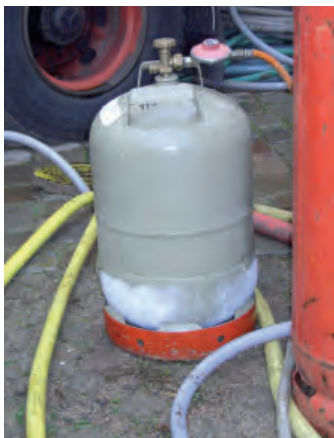
Abb. 4: Flüssiggasflasche mit Reifansatz; Flasche mit nicht geeignetem Druckregelgerät und unzureichende Aufstellung (verbotene Aufstellung im Verkehrsweg, Stolperstellen durch Schlauchleitungen)
