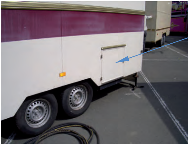
Abb. 37: Von außen zugänglicher Kasten (Schränk) für Flüssiggasflaschen
