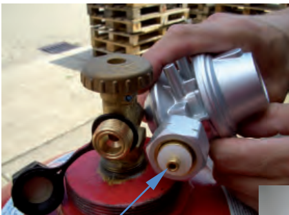
Abb. 16: Beispielhaftes Druckregelgerät (mit integrierter Überdrucksicherheitsvorrichtung) mit Kombinationsanschluss sowie Dichtring - Einsatz nur mit Dichtring, unabhängig vom Dichtsystem der Flasche (z. B. 5-kg-, 11-kg-, 33-kg-Flasche)
