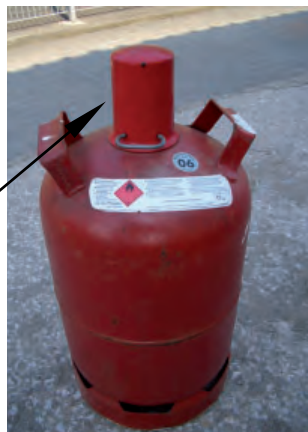
Abb. 42: Flüssiggasflasche mit Ventilschutzkappe
