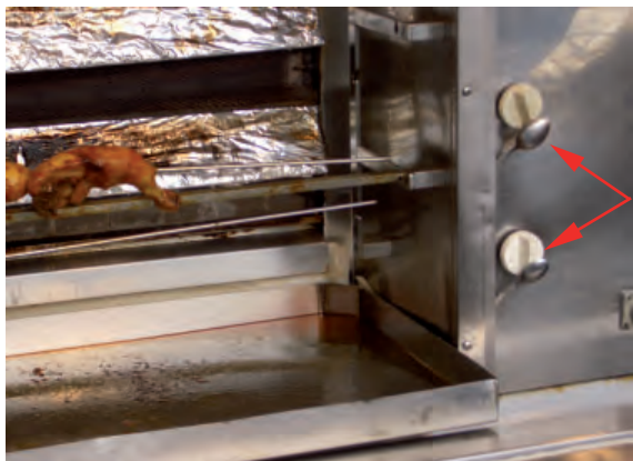
Abb. 32: Grillgerät eines Hähnchengrillwagens mit manipulierten Ventilen
